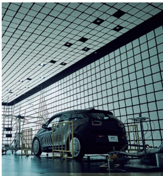
品質保証システム(右)の「車両」階層における実験検証の一つである「EMC試験」
