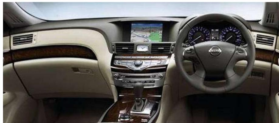
PU-RIM工法による表皮を使用、本革相当の質感を実現したインストルメントパネル(一体型インパネへの適用世界初)
